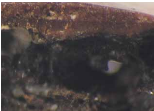
図7 内面側漆層の層断面 デジタル顕微画像 100×
