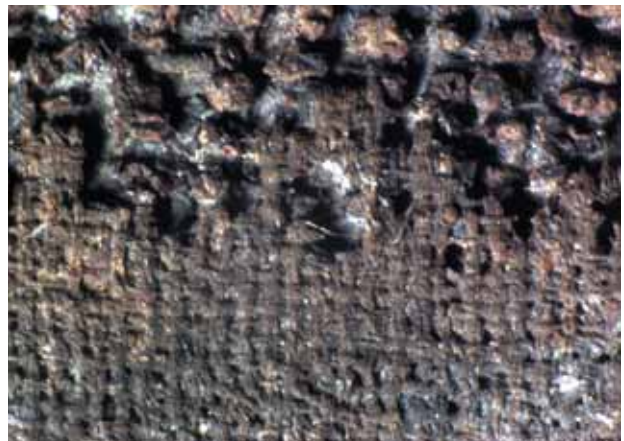
図4 内面側漆膜の裏面 麻布圧痕と絹布 12×
